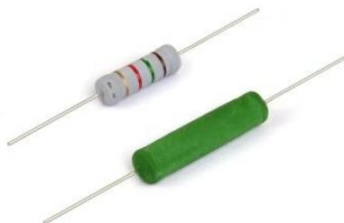
EWWR系列为经济型插脚线绕电阻, 电阻体积小, 电路设计更加灵活; 可选功率1W-10W, 阻值范围 $0.1\Omega \sim 8.2K\Omega$ , 最高精度可达 $\pm 5\%$ , 有效绝缘电压700V, 最高工作温度范围 $155^\circ\text{C}$ , 耐热性能好, 能够在相对高温下工作而不损坏, 能够稳定地在标称参数内负载工作, 在一些高温环境或需要长期负载的应用中表现优异, 产品可靠性高。
