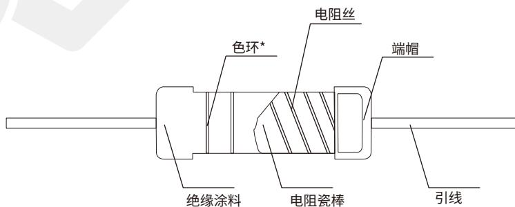
\*EWWR0008、EWWR0010的封装形式为绿色绝缘涂层，没有色环标识。
