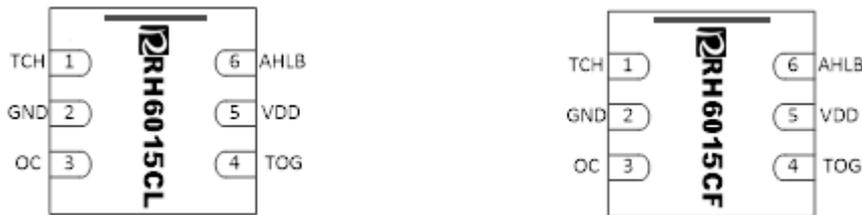
图 2 RH6015CL / RH6015CF (DFN6) 引脚示意图表
