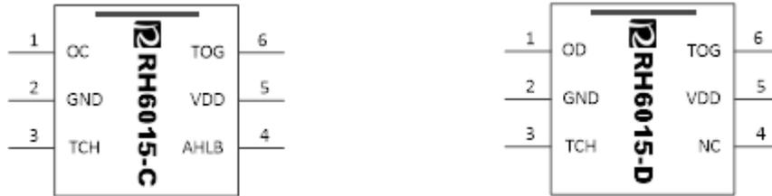
图 1 RH6015C[A/B] / RH6015D[A/B] (SOT23-6) 引脚示意图表
