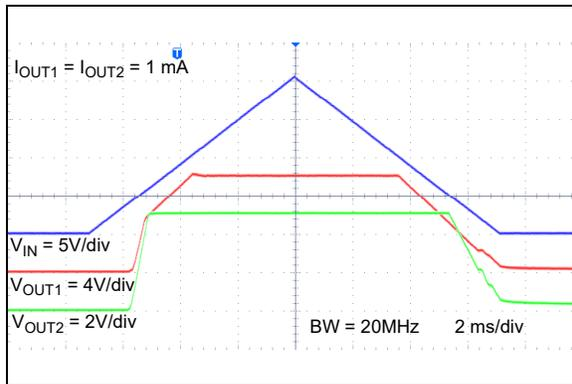
**FIGURE 2-26:** UVLO ( $V_R = 5.0\text{V}$  &  $V_R = 10\text{V}$ ).
