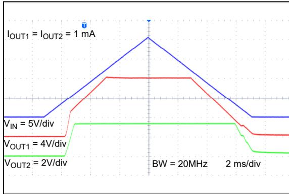
**FIGURE 2-25:** UVLO ( $V_R = 3.3\text{V}$  &  $V_R = 12\text{V}$ ).
