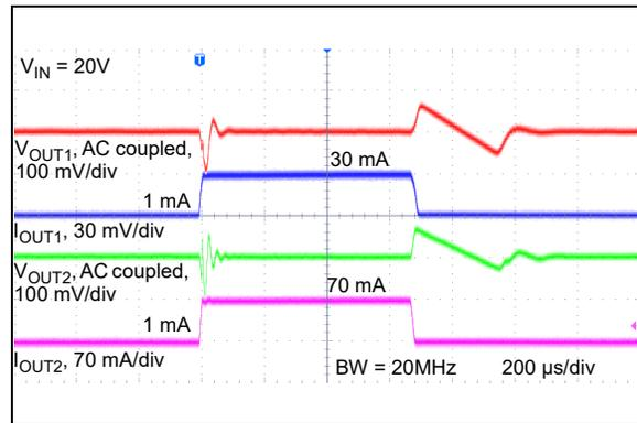
**FIGURE 2-35:** Dynamic Load Step ( $V_R = 3.3\text{V}$  &  $V_R = 12\text{V}$ ).
