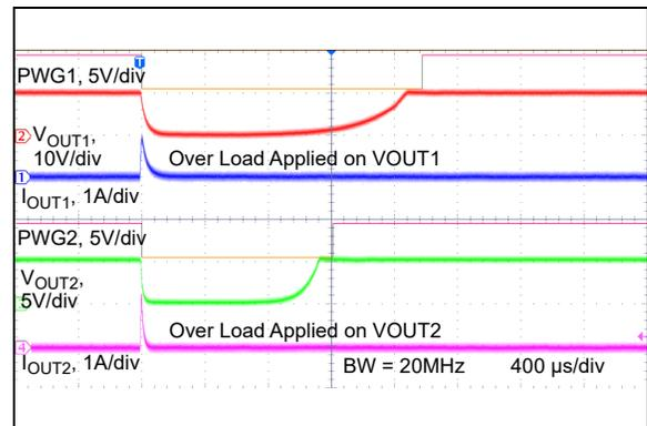
**FIGURE 2-42:** Power Good Fault Trigger ( $V_R=5\text{V}$  &  $V_R=10\text{V}$ ).
