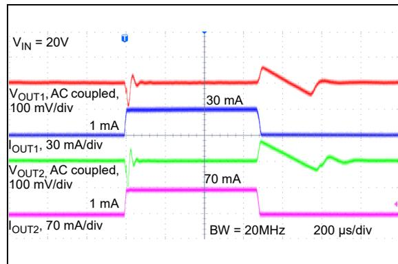
**FIGURE 2-36:** Dynamic Load Step ( $V_R = 5.0\text{V}$  &  $V_R = 10\text{V}$ ).
