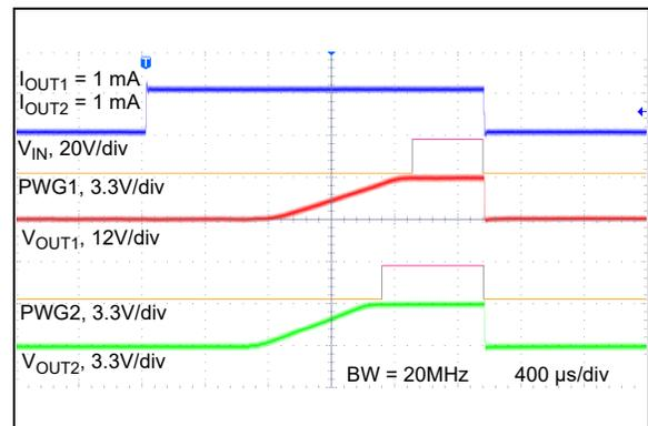
**FIGURE 2-41:** Power Good Transition ( $V_R=3.3\text{V}$  &  $V_R=12\text{V}$ ).
