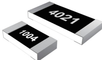
贴片薄膜电阻的长期稳定性非常重要, 离开稳定性的高精度没有任何意义。电阻的长期稳定性和三方面因素相关:时间, 功率和温度。加载的功率越大, 温度越高, 时间越长, 电阻的阻值变化就会越大。睿思推出的本系列薄膜电阻具有非常好的长期稳定性, +70°C的环境温度下加载额定功率, 2000小时后的阻值典型变化量小于+/-0.01%, 最大变化量小于+/-0.1% (大多数薄膜电阻该指标仅为+/-0.5%)。另外本产品在-55°C~+155°C的全温度范围内具有非常好的温度系数特性。
