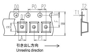
・シールテープ<sup>®</sup>剥離強度 The force to peel away the fixing seal tape 0.1~1.0N
