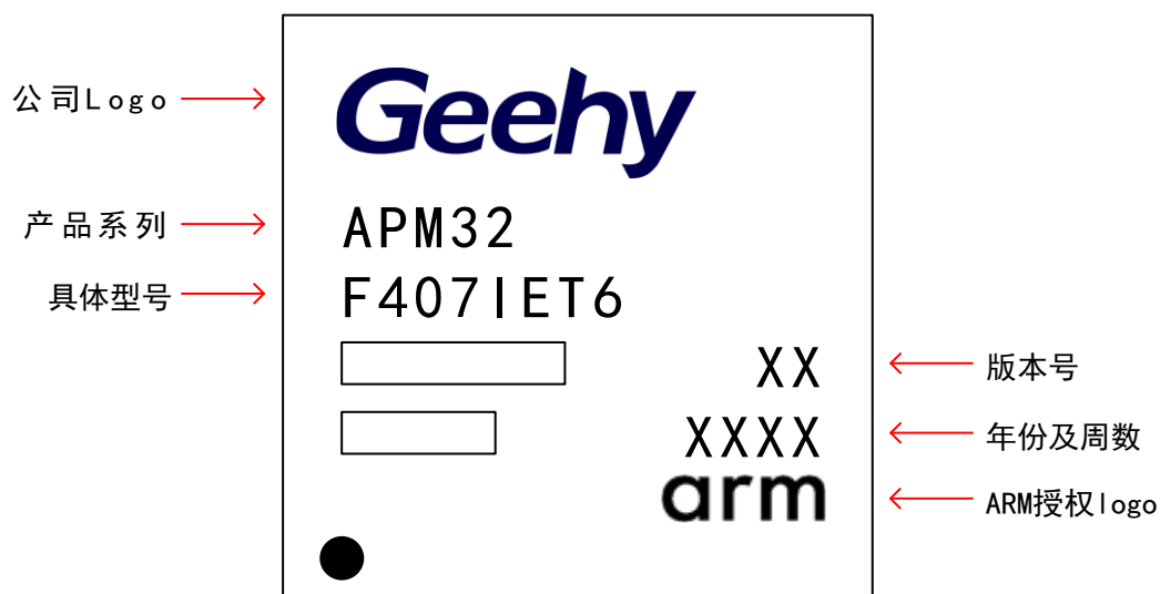
图 19 LQFP176 -176 引脚，24 x24 mm 标识图
