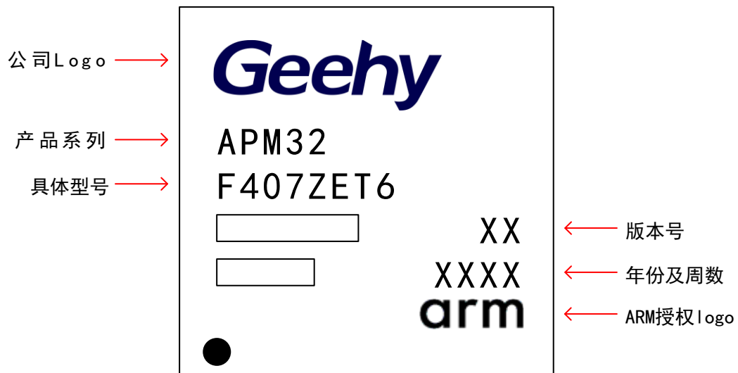
图 22 LQFP144 -144 引脚，20 x20 mm 标识图
