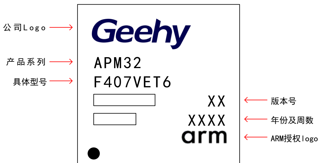
图 25 LQFP100 - 100 引脚，14 x 14mm 封装标识
