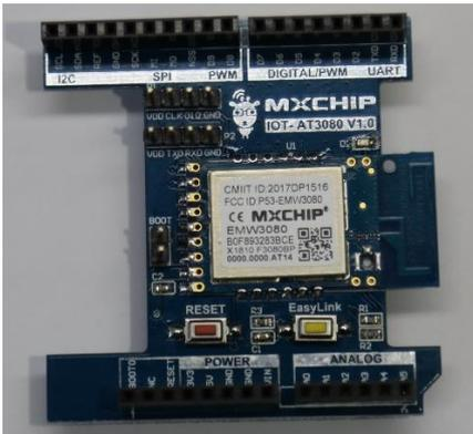
IOT-AT3080 开发板, 对外提供 Arduino 标准接口, 内置庆科 AT 指令, 一键直连各种云平台, 简洁灵活, 方便上手。
