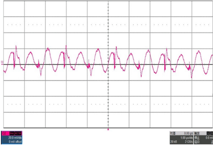
Noise & Ripple V_{IN}=42V , I_O=14A , 5~20MHz Bandwidth
