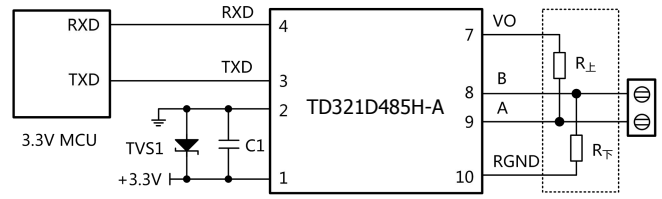
图 2.MCU 3.3V 供电应用电路
