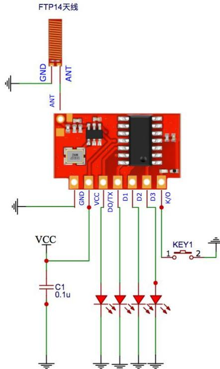
发射端用灵-T3A时，引脚对应灵-R1输出：K3-D0, K2-D1, K1-D2, K0-D3，如需更多按键，请选择串口模式，灵-T3A的4个按键可以组合，最多支持15个。
