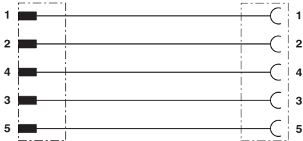
M12针式和M12孔式的触点分配
