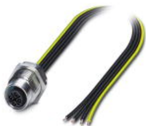
针式插座，电源，4-芯，孔式，M12，S电源，板后安装，M16 x 1.5，单线，电缆长度: 0.5 m
