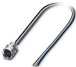
传感器/执行器插座式孔式连接器，4位，M8，板前/M8螺纹螺钉安装，带0.5 m PVC绞合线，4 x 0.25 mm²
