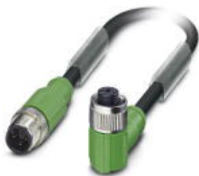
传感器/执行器电缆，4-芯，PUR 无卤素，黑-灰色 RAL 7021，屏蔽，插头 直头 M12，A编码，与 孔式 弯头 M12，A编码，电缆长度: 3 m
